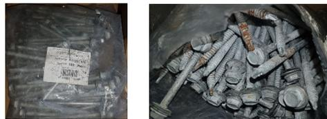
Attention au **serrage excessif** des fixations, utiliser des outils électroportatifs munis de dispositifs de serrage (**butée de profondeur**).
